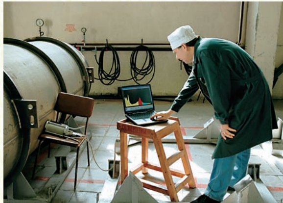
Замер обогащения урана неразрушающим методом контроля
