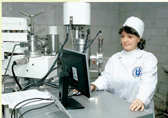
Выполнение измерений на газовом масс-спектрометре МИ 1201-АГМ01М
