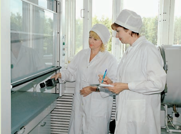
Замеры давления и скорости воздушного потока системы вентиляции
