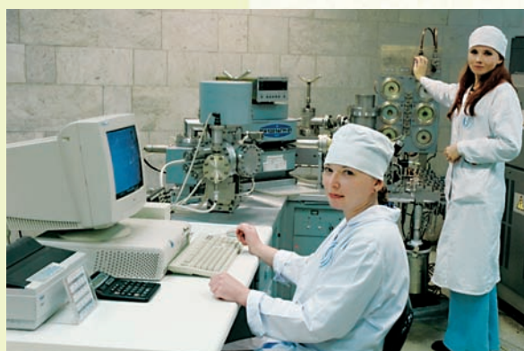
Выполнение измерений на газовом масс-спектрометре МИ 1201-АГМ01
