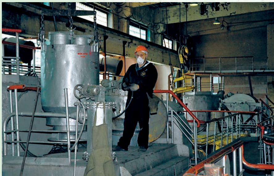
Загрузка уранового сырья в бункер аппарата УП
