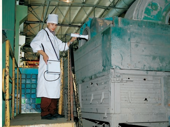
Радиационный контроль металлолома при отгрузке в автотранспорт
