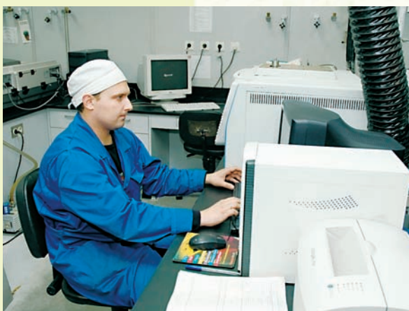
Измерение состава технологических газов производства хладонов на хроматографе ProGC+
